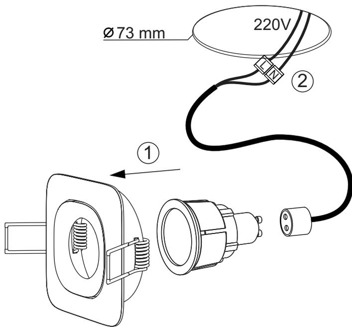
**ВАЖНО:** Установка светильника должна производиться при обесточенной электросети.
